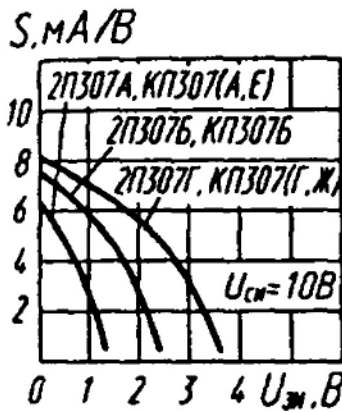
Зависимости крутизны характеристики от напряжения затвор—исток
