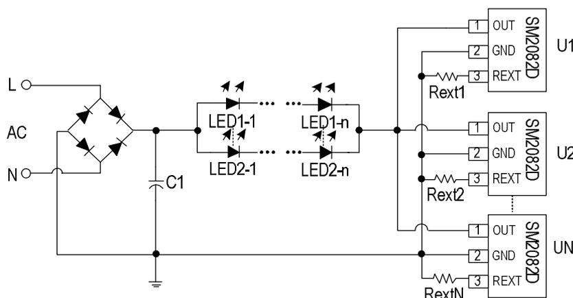
图 6. SM2082D 并联应用电路原理图
