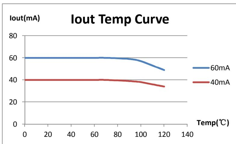
图 3. SM2082D 输出电流温度特性<sup>注3</sup>
