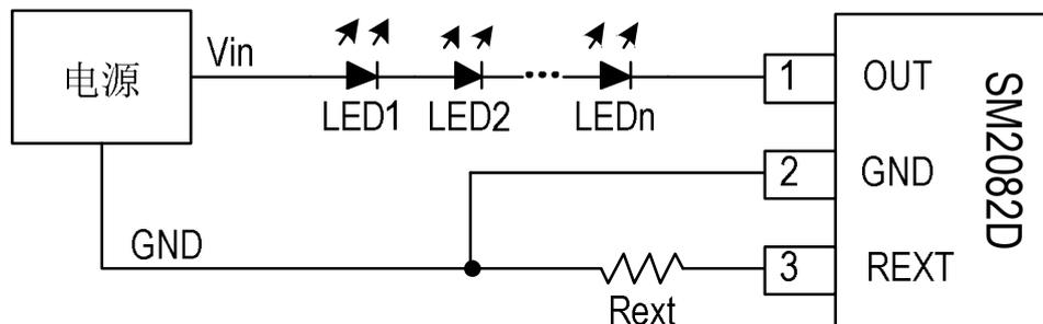
图 4. SM2082D 应用电路原理图
