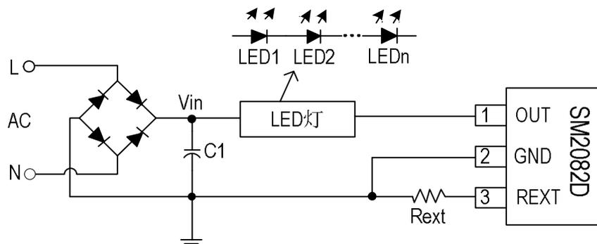
图 5 SM2082D 典型应用电路—交流电源输入
